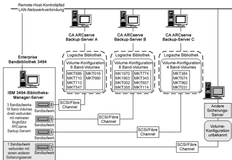
Das Beispiel zeigt, dass die Enterprise Tape Library 3494 über vier Bandlaufwerke verfügt, die direkt mit mehreren Sicherungsservern im Netzwerk verbunden sind. Die eindeutigen Band-Volume-Zuweisungen für die einzelnen CA ARCserve Backup-Server sehen folgendermaßen aus:
