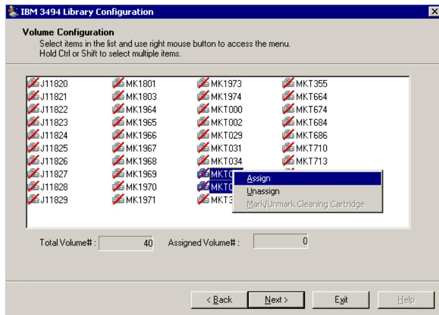
**Hinweis:** Die Band-Volumes sind dem CA ARCserve Backup-Server zunächst nicht zugewiesen. Der zuweisungslose Status wird durch einen roten Schrägstrich durch das Band-Volume-Symbol gekennzeichnet.
