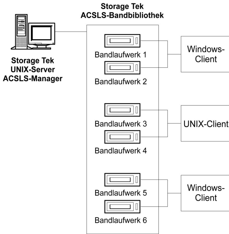
**Hinweis:** In Konfigurationen, bei denen mehr als ein Bandlaufwerk mit einem CA ARCserve Backup-Server verbunden ist müssen beide Bandlaufwerke Datenträger desselben Typs verwenden.
