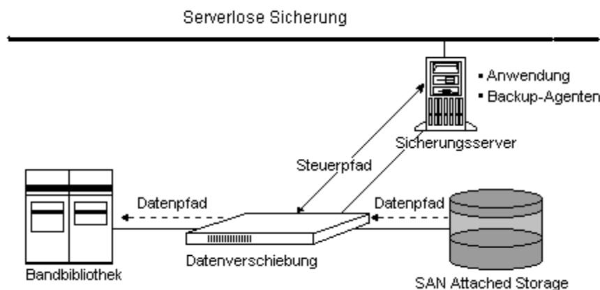
Die Serverless Backup Option überträgt Daten zwischen Datenträgern mit Hilfe der Data Mover. Dadurch müssen Daten nicht mehr zum Server transportiert werden, und es wird der kürzeste Datenpfad genutzt. Durch Data Mover wird die Sicherungsleistung merklich gesteigert und bei Sicherungen und Wiederherstellungen die Höchstgeschwindigkeit erzielt.
