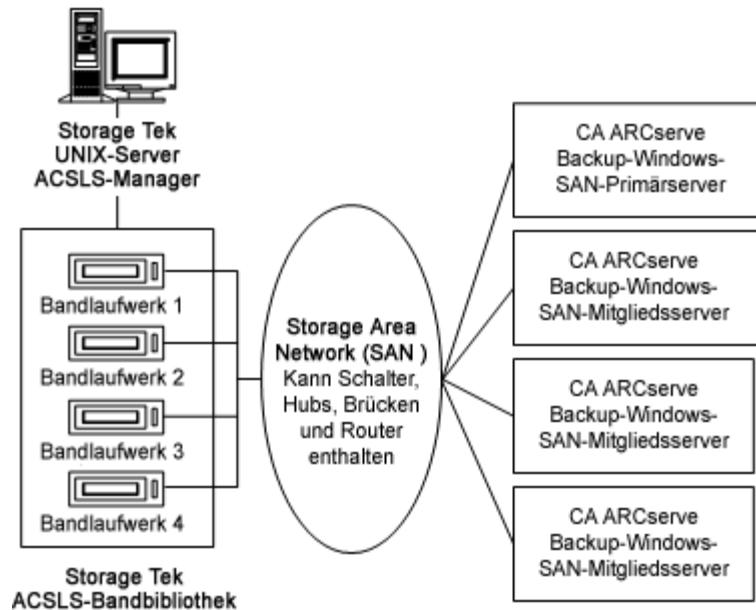
**Hinweis:** In Konfigurationen, bei denen mehr als ein Bandlaufwerk mit einem CA ARCserve Backup-Server verbunden ist müssen beide Bandlaufwerke Datenträger desselben Typs verwenden.
