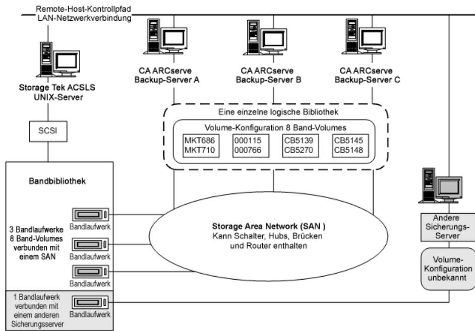
Die Abbildung zeigt, dass die StorageTek ACSLS-Bandbibliothek über drei direkt mit einem SAN verbundene Bandlaufwerke verfügt. Die Band-Volume-Zuweisungen sind für jeden CA ARCserve Backup-Server im SAN die gleichen. Ein weiterer Sicherungsserver im Netzwerk, auf dem CA ARCserve Backup nicht ausgeführt wird, kann auf andere Weise konfiguriert sein.
