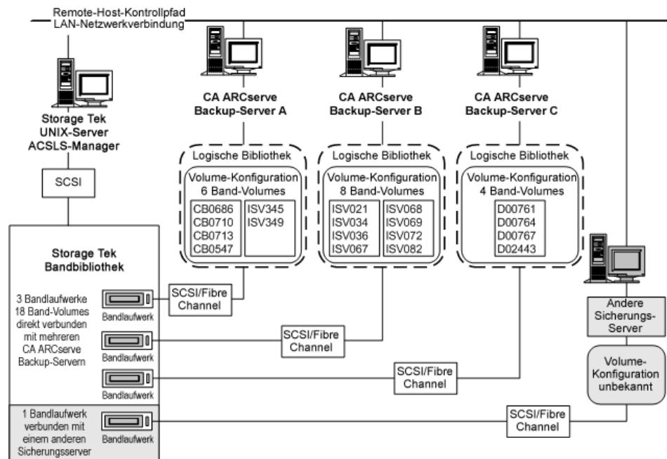
Das Beispiel zeigt, dass die StorageTek ACSLS-Bandbibliothek über vier Bandlaufwerke verfügt, die direkt mit mehreren Sicherungsservern im Netzwerk verbunden sind. Die spezifischen Band-Volume-Zuweisungen für die einzelnen CA ARCserve Backup-Server sehen folgendermaßen aus:
