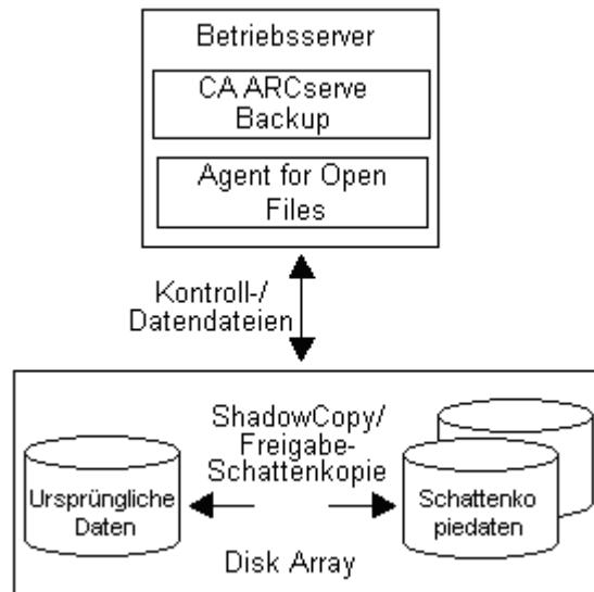
Die folgende Abbildung zeigt die Remote-Konfiguration des unterstützten Client für VSS Software Snap-Shot:
