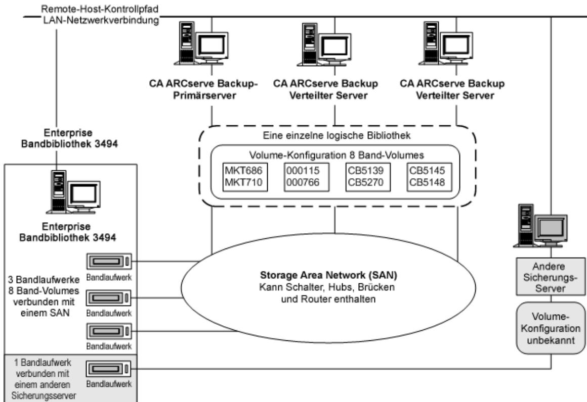
Das Beispiel zeigt, dass die Enterprise Tape Library 3494 über drei direkt mit einem SAN verbundene Bandlaufwerke verfügt. Die Band-Volume-Zuweisungen sind für jeden CA ARCserve Backup-Server im SAN die gleichen. Ein weiterer Sicherungsserver im Netzwerk, auf dem CA ARCserve Backup nicht ausgeführt wird, kann auf andere Weise konfiguriert sein.
