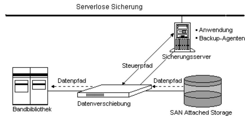
Die Serverless Backup Option überträgt Daten zwischen Datenträgern mit Hilfe der Data Mover. Dadurch müssen Daten nicht mehr zum Server transportiert werden, und es wird der kürzeste Datenweg genutzt. Durch Data Mover wird die Sicherungsleistung merklich gesteigert und bei Sicherungen und Wiederherstellungen die Höchstgeschwindigkeit erzielt.
