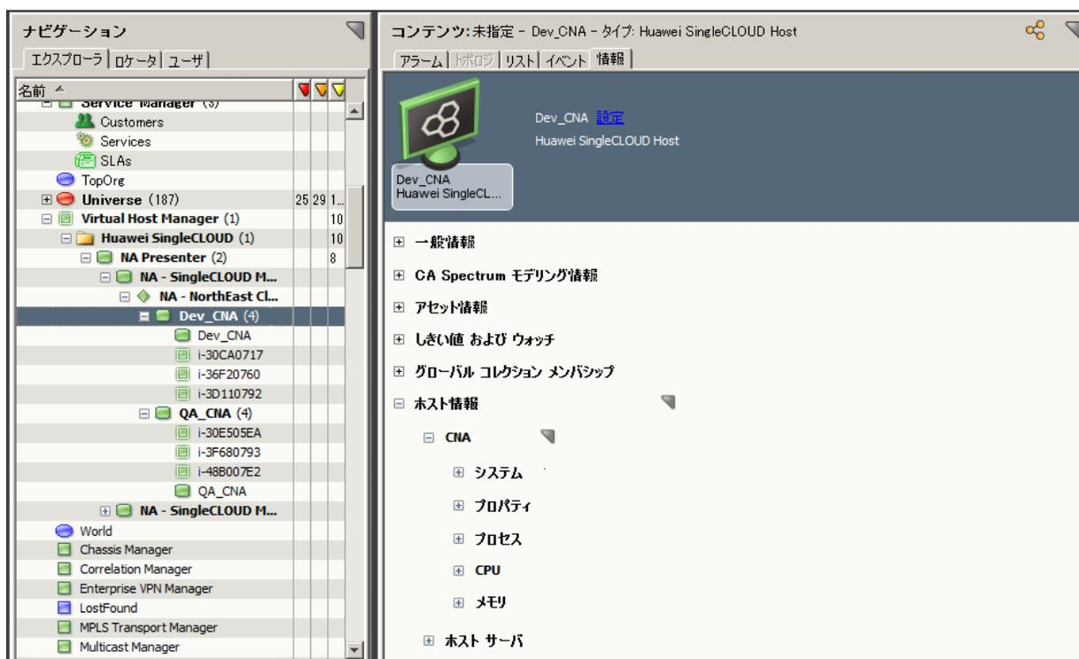
注: Huawei SingleCLOUD マネージャ モデルは、Huawei SingleCLOUD マネージャが管理するすべての仮想デバイスに対する結合情報を提供します。ナビゲーション画面内で Huawei SingleCLOUD マネージャ モデルを選択すると、Huawei SingleCLOUD GalaX OMM、管理対象のすべての Huawei SingleCLOUD クラウド、ホストおよび仮想マシンに関する結合情報など、一意の情報が表示されます。この情報には、個別のエンティティ モデルの [情報] タブに表示されるのと同じデータの一部が含まれます。Huawei SingleCLOUD マネージャ モデル内の結合ビューでは、管理対象のすべての仮想エンティティに関する概要が簡単に確認できます。
