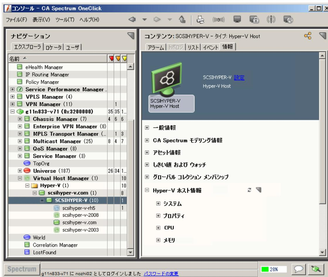
注: Hyper-V マネージャ モデルは、Hyper-V マネージャが管理するすべての仮想デバイスに対する結合情報を提供します。すなわち、ナビゲーション画面で Hyper-V マネージャ モデルを選択すると、選択した Hyper-V マネージャ ホストに関する情報と、すべての Hyper-V ホストおよび Hyper-V 仮想マシンに関する結合情報が表示されます。この情報は、個別のエンティティ モデルの [情報] タブに表示される情報と同じデータです。Hyper-V マネージャ モデル内の結合ビューにより、管理対象のすべての仮想エンティティの概要が把握しやすくなります。
