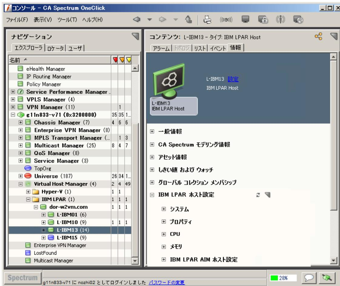
**注:** IBM LPAR マネージャ モデルは、IBM LPAR マネージャが管理するすべての仮想デバイスに対する結合情報を提供します。すなわち、ナビゲーション画面で IBM LPAR マネージャ モデルを選択すると、選択した IBM LPAR マネージャ ホストに関する情報と、すべての IBM LPAR ホスト、IBM LPAR インスタンス、システム プロファイル、仮想イーサネットデバイスなどに関する結合情報が表示されます。この情報は、個別のエンティティ モデルの [情報] タブに表示される情報と同じデータです。IBM LPAR マネージャ モデル内の結合ビューにより、管理対象のすべての仮想エンティティの概要が把握しやすくなります。
