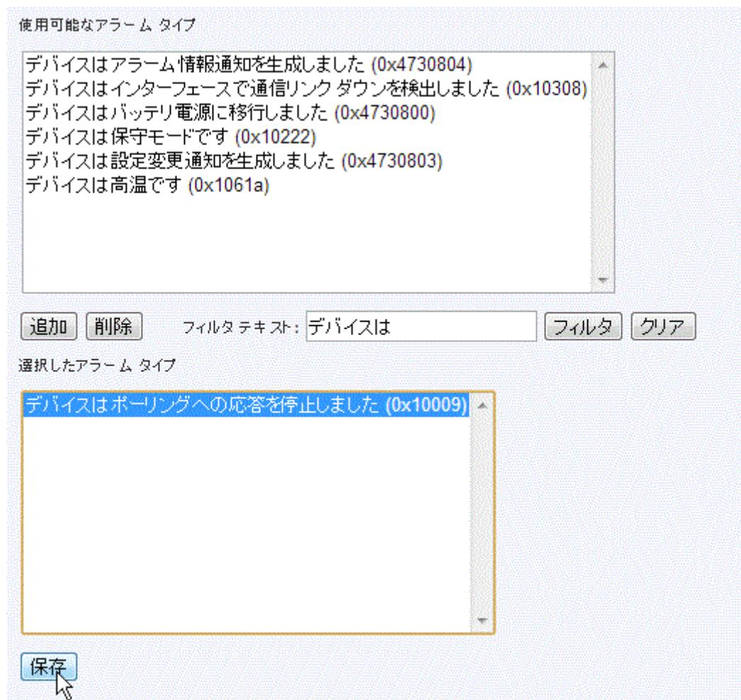
この例では、タイプ DEVICE HAS STOPPED RESPONDING TO POLLS (0x10009) の CA Spectrum アラームは、対応する CA Service Desk チケットを生成します。以下の図では、タイプ 0x1009 の CA Spectrum アラームのインスタンスを示します。[トラブルチケット ID] 列には、このアラームに対して自動的に作成された CA Service Desk チケットへのリンクが含まれます。
