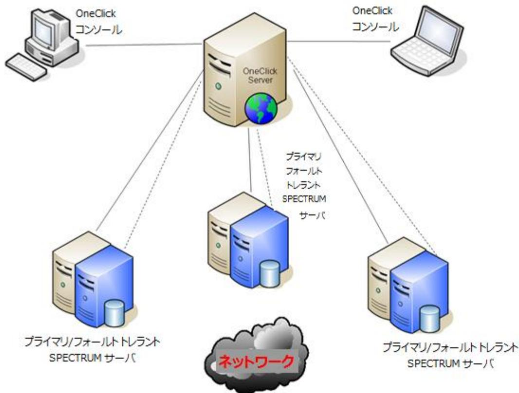
リモート オペレーション スイートを使用すると、一連のリモートまたはモバイル ネットワーク デバイスを管理するため、複数のリモート オペレーション サーバを展開することができます。インベントリ 情報（デバイスやインターフェース 情報など）と関連するアラーム データを、指定したプライマリ **Central SPECTRUM** サーバに転送するように、各リモート オペレーション サーバを設定することができます。プライマリ **Central SPECTRUM** サーバは、複数のリモート オペレーション サーバの集約 ポイントとして動作します。セントラル サイトの管理者は、プライマリ **Central SPECTRUM** サーバで 1 台ずつ確認することで、リモート オペレーション サーバから転送されたすべての情報にアクセスします。
