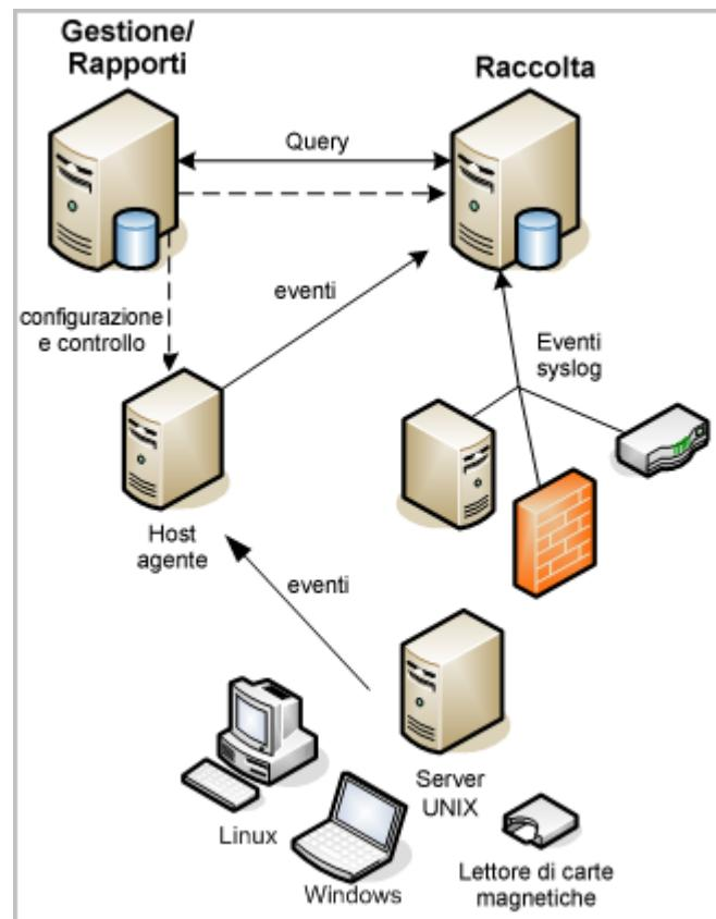
Un sistema CA Enterprise Log Manager può avere uno o più server, laddove il primo server installato è il server di gestione. Non può essere presente più di un server di gestione in un sistema, ma è possibile avere diversi sistemi. Il server di gestione conserva contenuti e configurazione di tutti i server CA Enterprise Log Manager ed esegue l'autorizzazione e l'autenticazione degli utenti.
