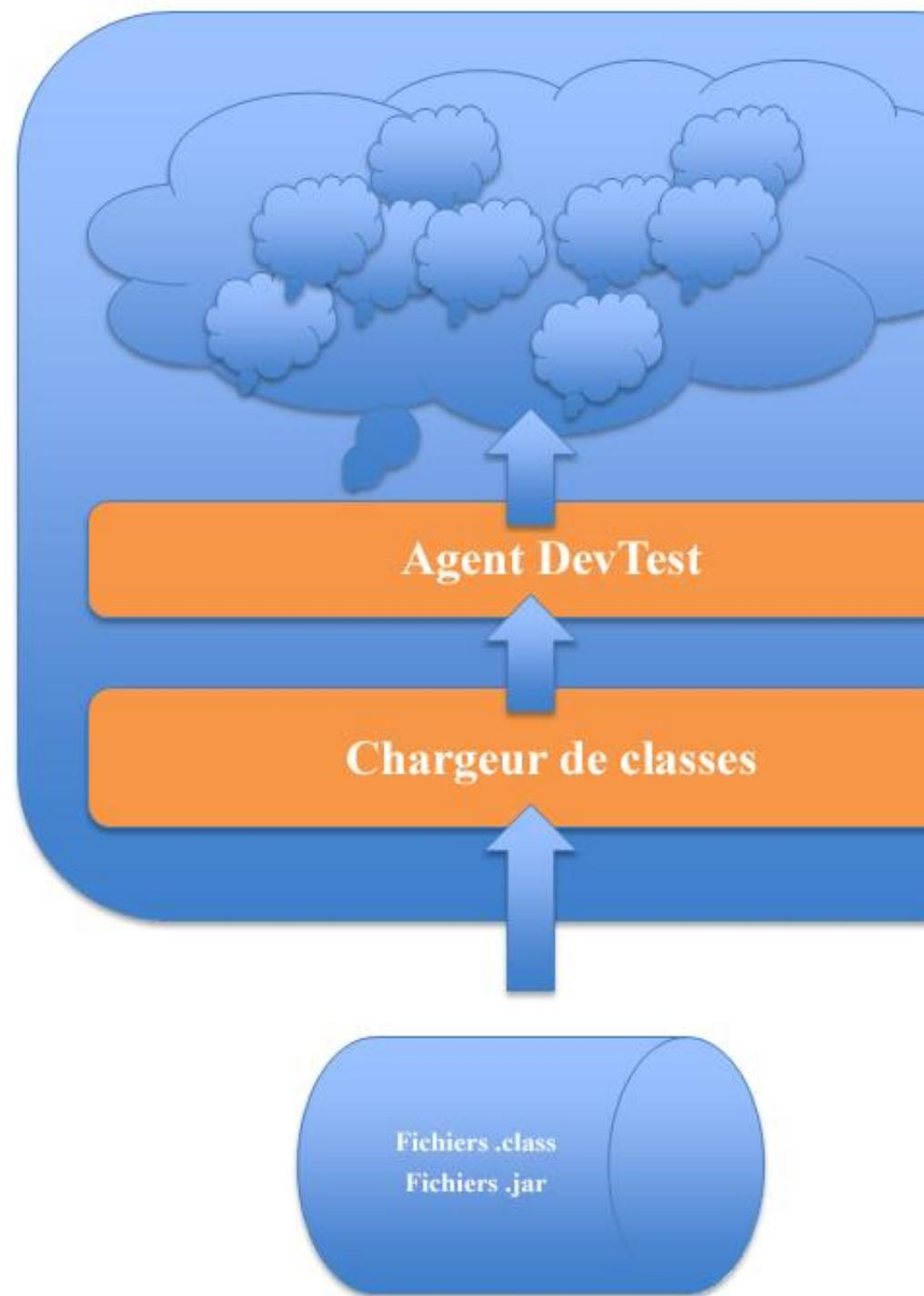
Un agent est mis en package dans un fichier .jar. La machine virtuelle Java doit être configurée avec le chemin d'accès au fichier .jar. A partir de Java 1.5, vous devez utiliser une chaîne commençant par **-javaagent** pour spécifier le chemin d'accès et les options de votre choix. Par exemple :
