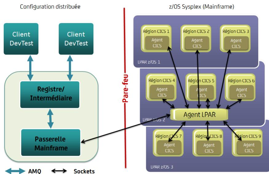
Une fois la connexion établie, le trafic part des clients DevTest vers l'intermédiaire, vers la passerelle Mainframe, vers le système Mainframe réel. Le trafic peut également partir dans l'ordre inverse.
