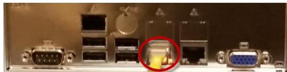
2. Multi-Port Monitor Web インターフェースのネットワーク アクセスを許可するスイッチに管理ケーブルのもう一端を接続します。
