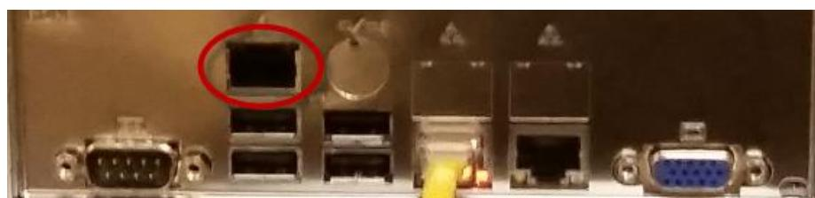
注: アプライアンスの電源をオンにする前に、RJ45 ケーブルを専用 IPMI ネットワークポートに接続してください。 電源がオンになった時点で専用 IPMI ポートがネットワークに接続されていない場合、BMC コントローラは代わりに使用する共有 LAN ポートを探します。 間違ったポートが使用されているか、設定を後で変更したい場合は、新しい IPMI ポートが検出されるように、必ずアプライアンスの電源を入れ直してください。
